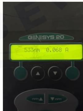
Pengukuran absorbansi menggunakan spektrofotometri dengan panjang gelombang 553nm
