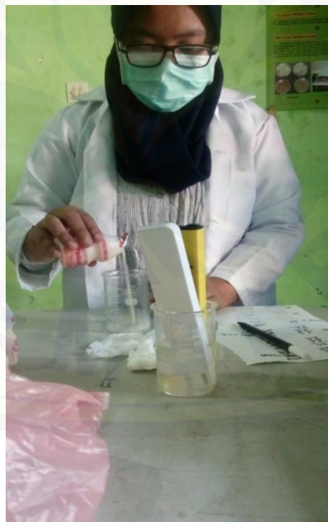
Menuangkan sampel untuk pengukuran pH menggunakan pHmeter
