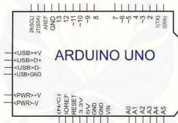
Gambar 2.2 Modul arduino UNO
