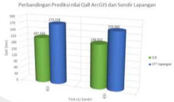
Gambar 8. Diagram Perbandingan Analisis ArcGIS Dengan Sondir Lapangan Untuk Footplate Ukuran 1,6mx1,6m
