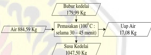
Gambar 6. Diagram kesetimbangan massa produksi tahu
