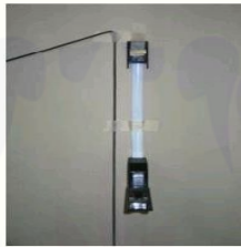
Tarik papan penggeser tegak lurus keatas, sejajar dengan benang berbandul. Paku atau selotip pd dua bagian dengan jarak 10 cm
