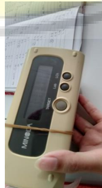
Pengukuran derajat putih menggunakan colour reader
