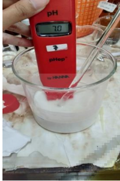
Penambahan NaOH 0,1 N (pengaturan pH 7)
