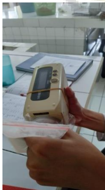
Pengukuran derajat putih menggunakan colour reader
