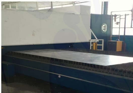
Gambar 4 Penempatan Plat Pada Pallet Sumber : Dokumentasi Pribadi
