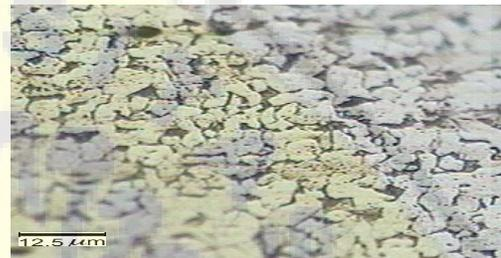
Gambar 4: Struktur Mikro Baja Karbon Rendah S30C
