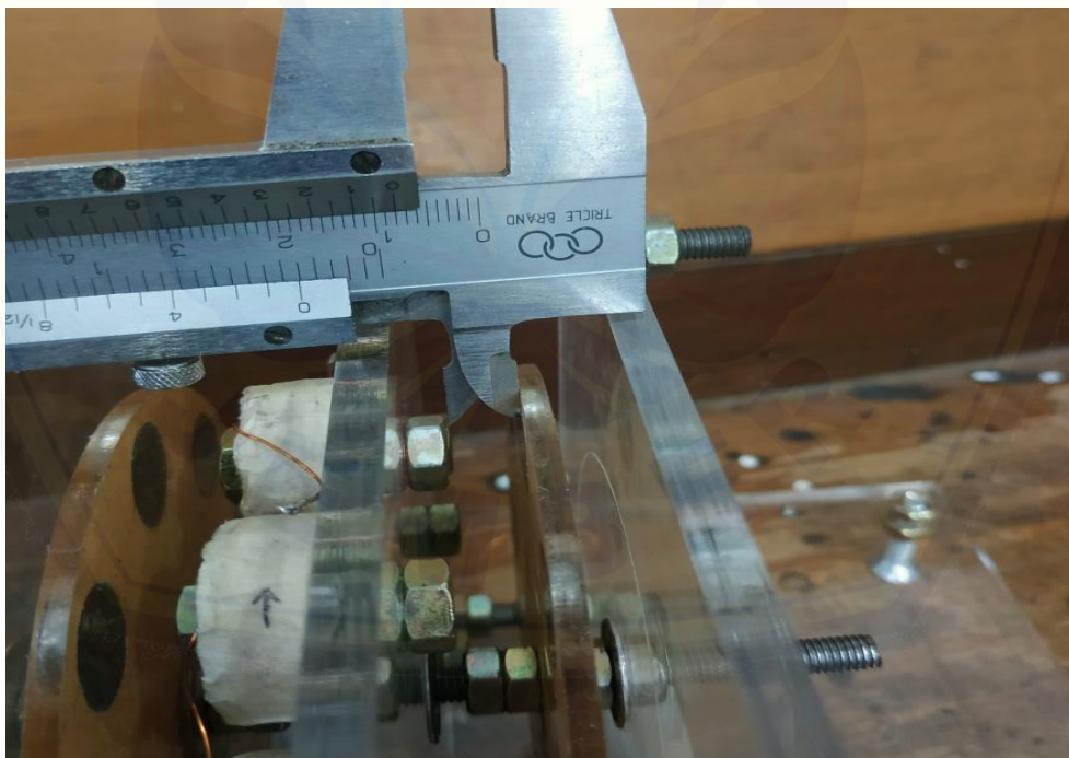
Gambar 6. Pengukuran Jarak Celah Udara 8 mm Menggunakan Jangka Sorong
