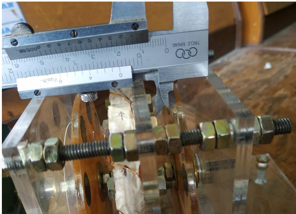
Gambar 7. Pengukuran Jarak Celah Udara 9 mm Menggunakan Jangka Sorong
