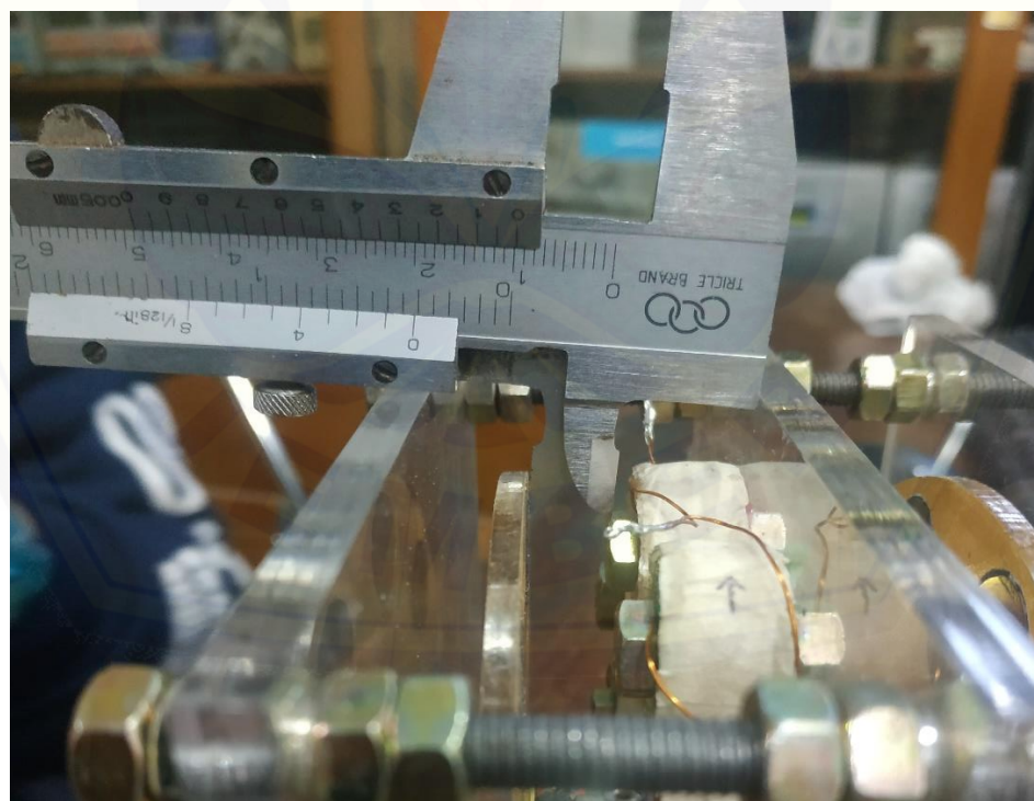
Gambar 8. Pengukuran Jarak Celah Udara 10 mm Menggunakan Jangka Sorong
