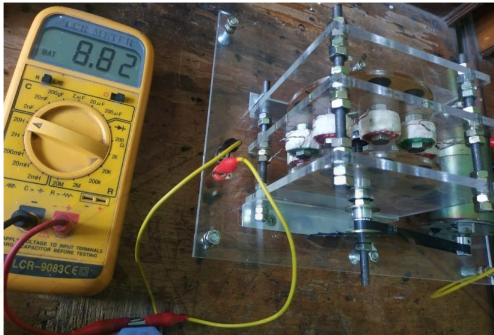
Gambar 5. Pengukuran Induktansi Kumparan ( X_a )
