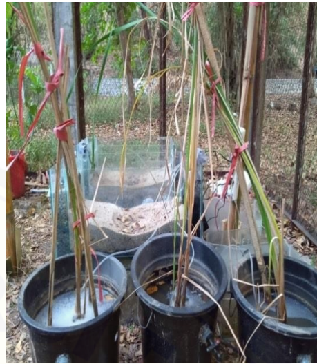
Proses penanganan air limbah menggunakan tanaman typha angustifolia
