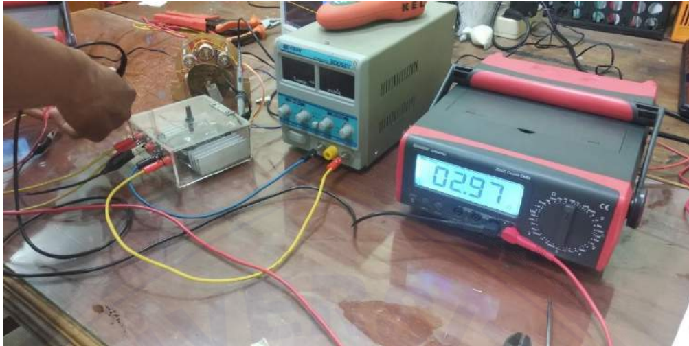
Pengukuran R_0 Pada Kumparan Kawat Enamel
