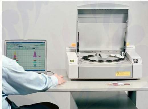
Gambar 2.4 Alat XRF ( Sumber : http://central-laboratory.um.ac.id/ )
