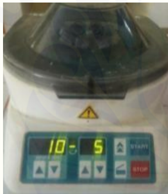
Gambar 3. Tabung diputar selama 5 menit dengan kecepatan 1000 RPM
