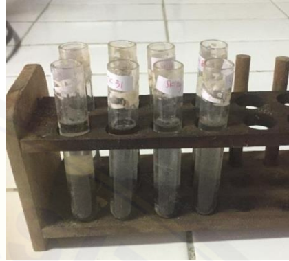
Gambar 2. Sampel tanah di campur 8mL aquades
