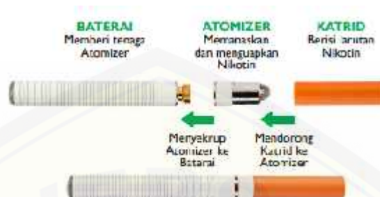
Gambar 2. 4 Struktur dasar rokok elektrik (BPOM, 2015).
