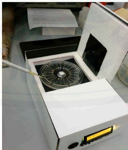
Gambar 2.2 Prototype LOCD ELISA Reader (Sumber: Thiha dan Fatimah, 2015)
