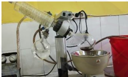
Gambar 12. Proses Penguapan dengan Rotary Evaporator
