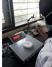
Penimbangan NaOH teknis
