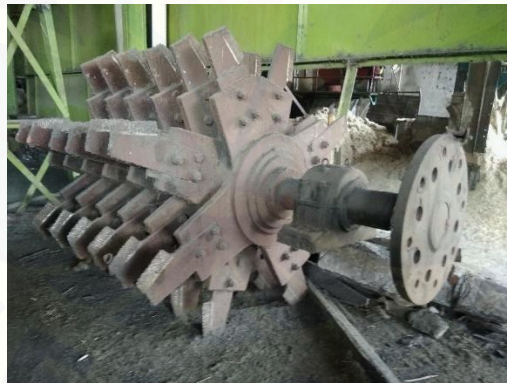
Gambar 2.9 Poros dan Piringan Cane Cutter
