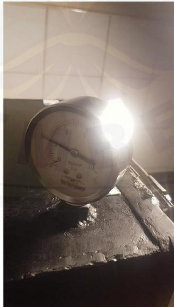
Gambar A.2 Tekanan ruang pengujian 2 bar
