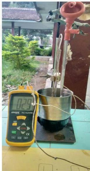
Gambar 3.4 *Thermocouple* pada *viscometer Oswald*
