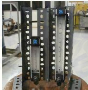
Gambar 3.3 Flowmeter bahan bakar dan udara
