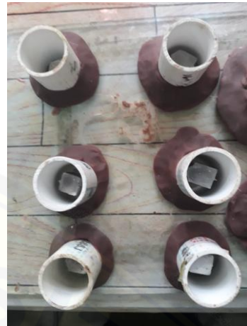
Pembuatan spesimen uji mikro
