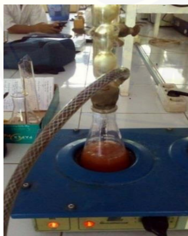
Hidrolisis oleh \text{H}_2\text{SO}_4 0,5 M pada pendingin balik
