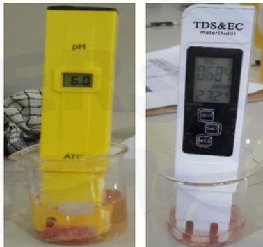
Gambar 3.8 Pengukuran dengan pH meter dan TDS & EC meter
