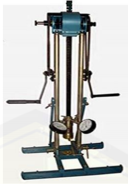
Gambar 3. 1. Alat uji sondir.
