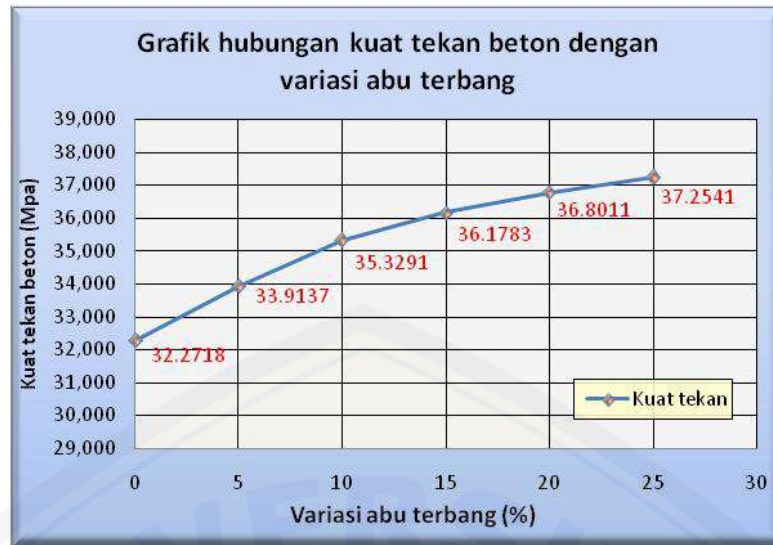
Gambar 2.4 Grafik Hubungan Kuat tekan beton dengan variasi fly ash
