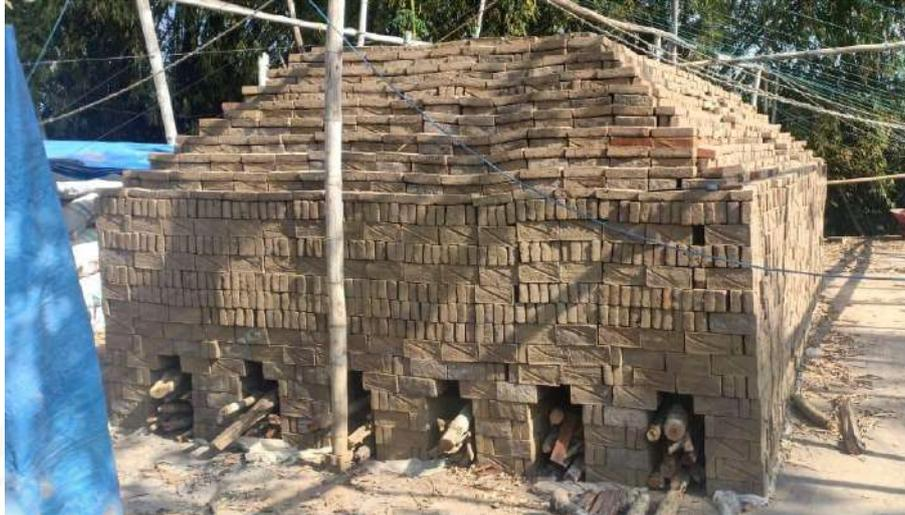
Pada proses pembakaran batu bata merah, pembuat batu bata merah membutuhkan waktu 24 jam pembakaran. Pada proses pembakaran, pembuat batu bata merah membutuhkan 4 pick up kayu dan 75 karung sekam. Pada proses tersebut dalam satu kali pembakaran dapat membakar 36.000 buah batu bata merah.
