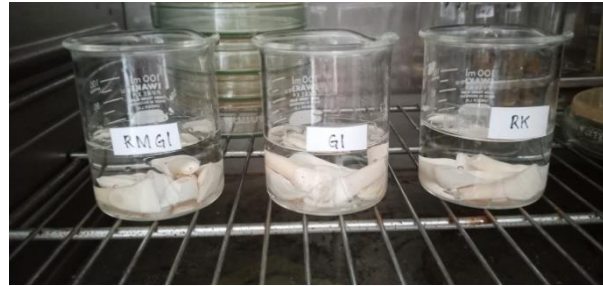
Gambar 3. 18 Tahap perendaman dalam akuades bersuhu 37°C selama 24 jam dalam inkubator (Sumber: Koleksi pribadi, 2020)
