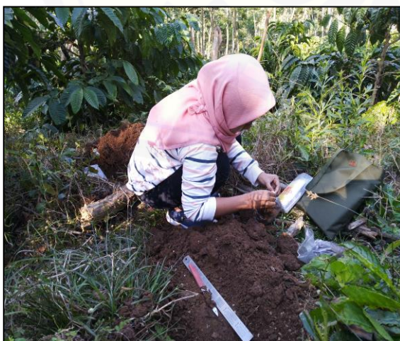
Gambar 5. Pengambilan contoh tanah
