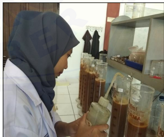
Gambar 6. Analisis tekstur tanah
