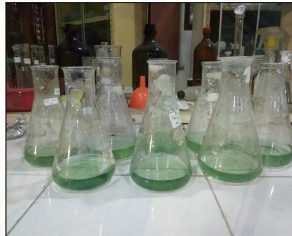
Gambar 4. Analisis KTK tanah
