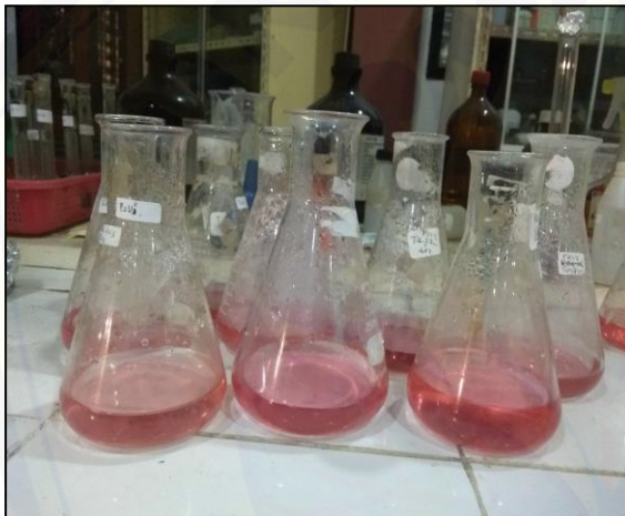
Gambar 3. Analisis N Total tanah
