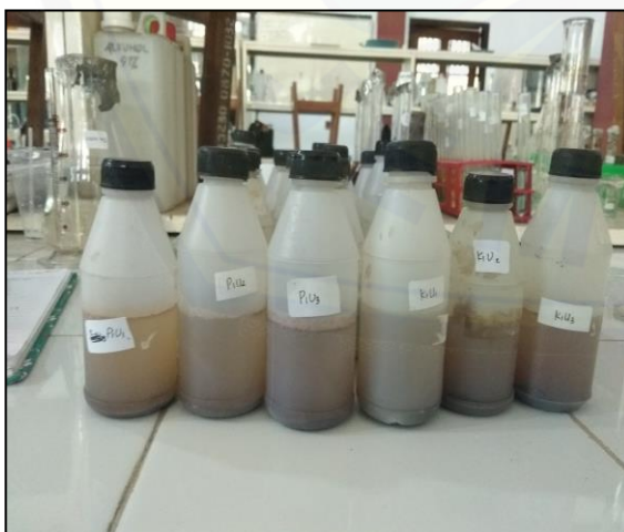
Gambar 5. Analisis pH (H 2 O) tanah
