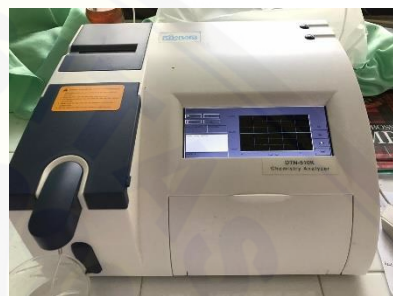
Pengukuran kadar SGOT dan SGPT menggunakan fotometer
