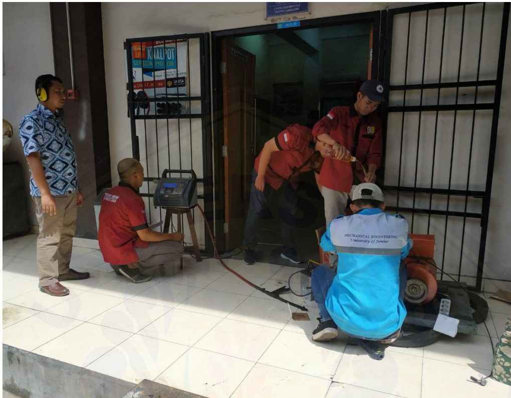
Gambar 4. Proses pengujian opasitas mesin diesel
