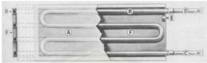
Gambar 2.13 Evaporator Plat dengan Pipa (Syamsuri Hasan dkk., 2008)
