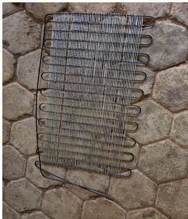
Gambar 3.17 Kondensor Jarak Fin 5 mm Berdiameter 2 mm
