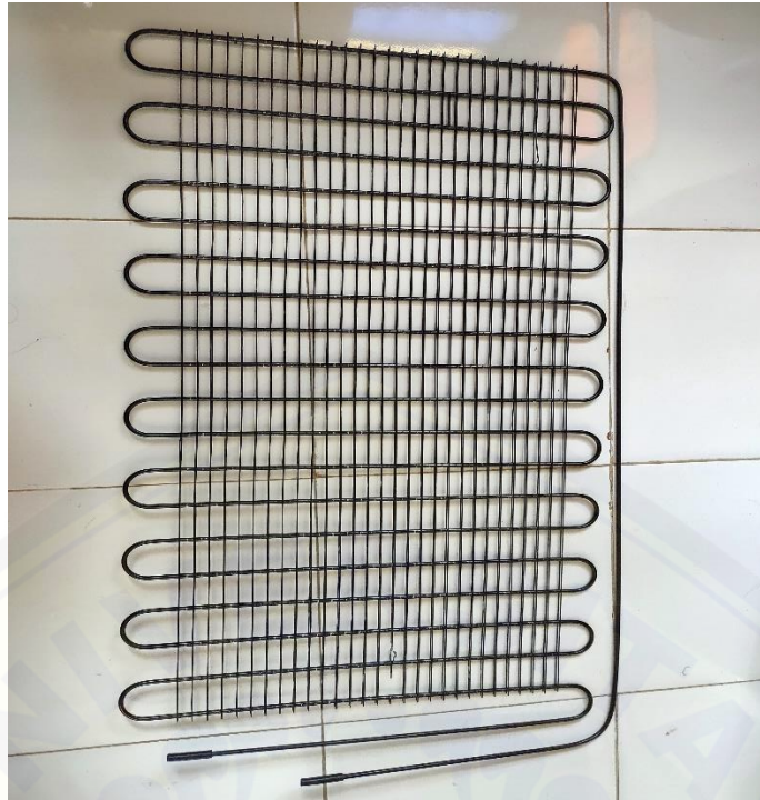
Gambar 3.18 Kondensor Jarak Fin 10 mm Berdiameter 1 mm
