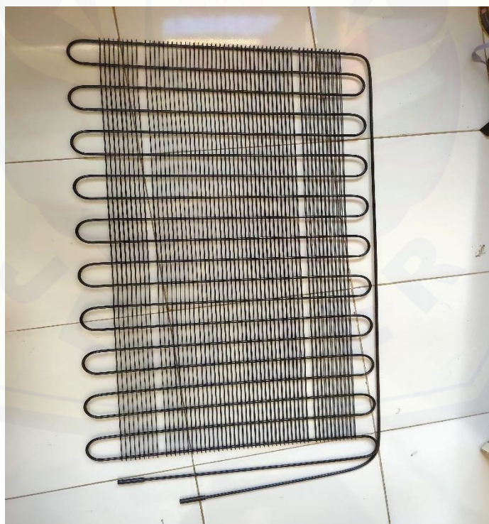
Gambar 3.19 Kondensor Jarak Fin 5 mm Berdiameter 1 mm
