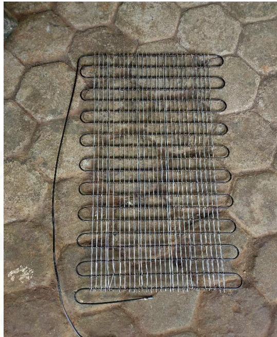
Gambar 3.16 Kondensor Jarak Fin 10 mm Berdiameter 2 mm
