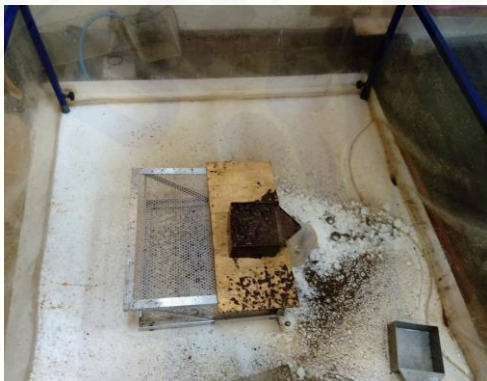
Pengujian erosi menggunakan alat rainfall simulator
