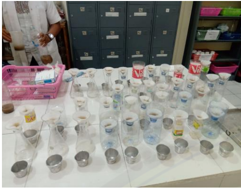
Penyaringan larutan sedimen menggunakan kertas saring
