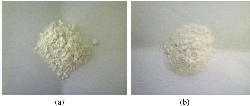
Gambar 4.1 Mocal (a) sebelum pencucian, (b) setelah pencucian
