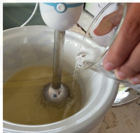
Pencampuran larutan KOH dan minyak
