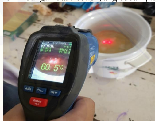
Pengukuran suhu pencairan sabun cair
