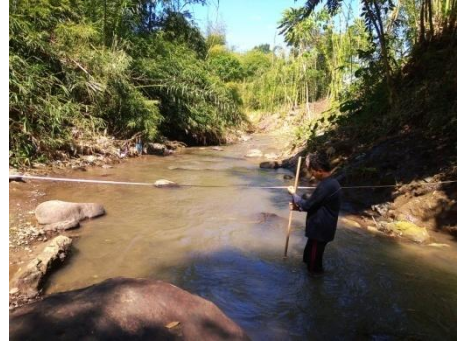
Pengukuran kedalaman sungai (ST02)
