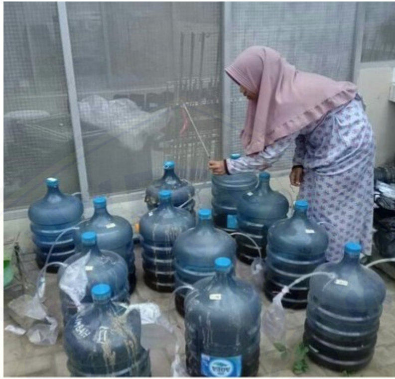
g. Pengukuran suhu dan volume biogas
