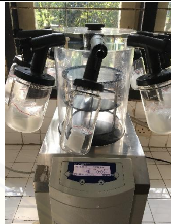
Proses enkapsulasi HPI tawes dengan metode freeze drying
