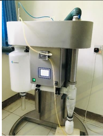
Proses enkapsulasi HPI tawes dengan metode spray drying
