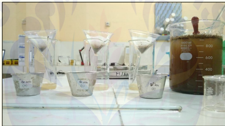
2. Penyaringan tanah yang tercampur dengan air menggunakan kertas saring
