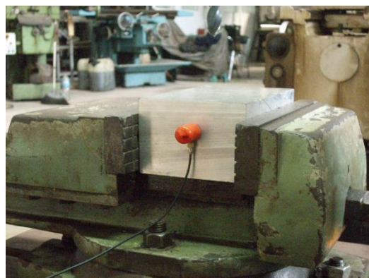
Accelerometer pada benda kerja
