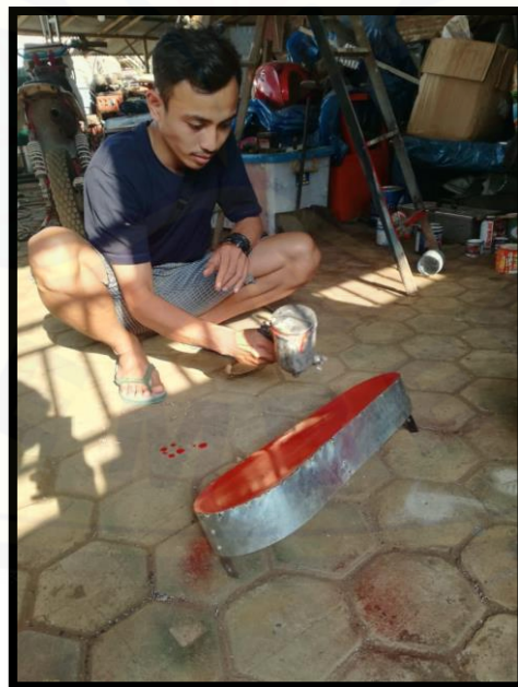
Gambar C.6 Pengecatan pada penutup pulley
