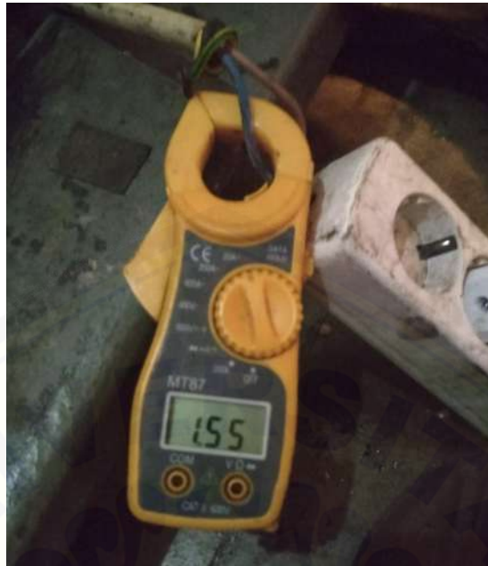
Gambar 4. Pengambilan data arus listrik yang dihasilkan saat pengujian mesin diesel menggunakan bahan bakar B30 pada putaran mesin 2200 rpm
