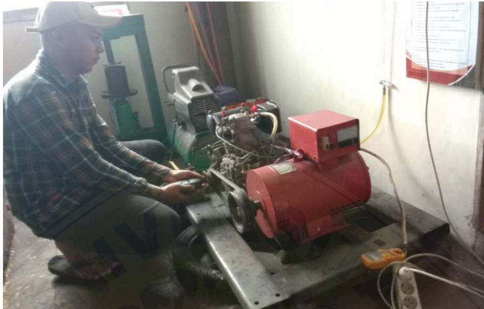
Gambar 2. Proses pengujian unjuk kerja mesin diesel
