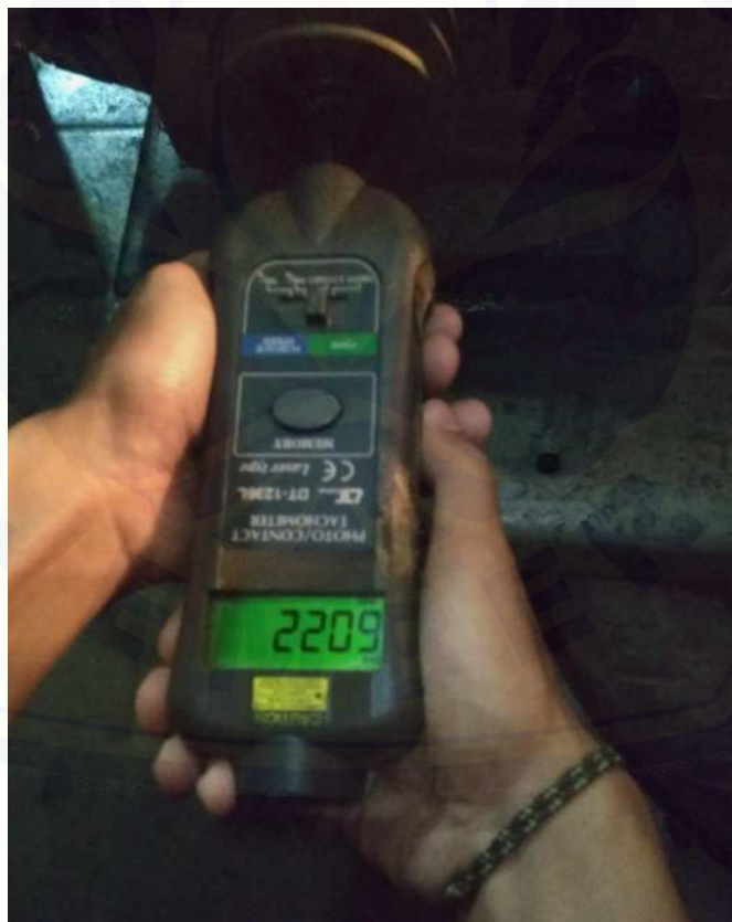
Gambar 3. Proses pengambilan data pada putaran mesin 2200 rpm
