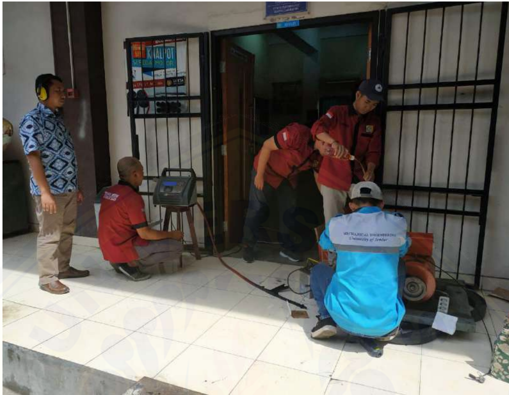
Gambar 6. Proses pengujian opasitas mesin diesel
