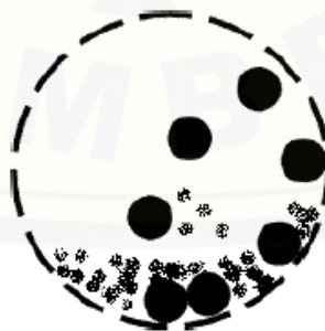
Gambar 2.14 Material dan bola penghancur didalam vial (dinding vial = lingkaran dengan garis putus-putus, bola penghancur = bulat hitam besar, material = bulat hitam kecil).(Fahlefi Diana,2010)
