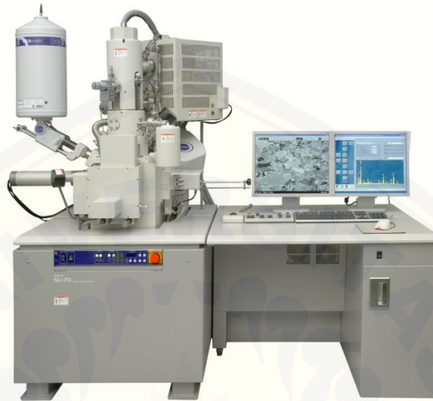
Gambar 2.17 Mesin uji SEM untuk mengetahui bentuk morfologi nanopartikel.
