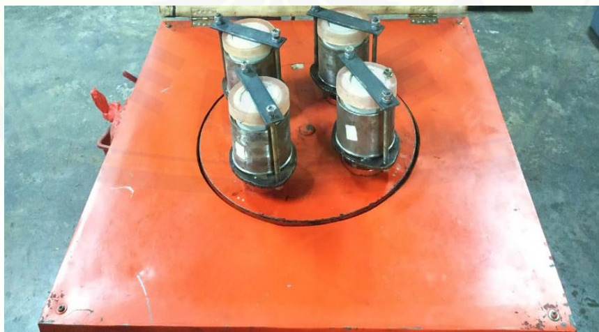
Gambar 3.5 Mangkok yang sudah diletakkan plat penyangga
