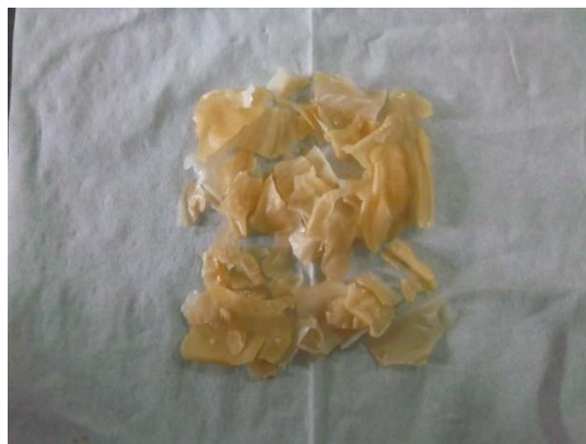
Gambar 4.2 Kopolimer yang tidak homogen
