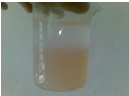
Gambar 4.3 Pencucian suspensi kopolimer dengan aquades
