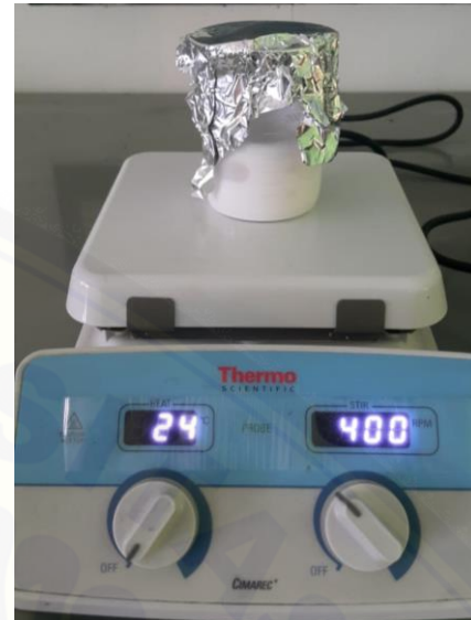
2.4 Proses pelarutan dispersi \text{TiO}_2 dengan aquades
