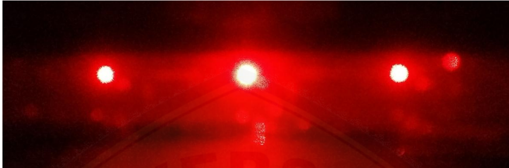
Gambar F1 Pola difraksi saat menggunakan spektrum warna merah ( \lambda = 632,8 \text{ nm} )
