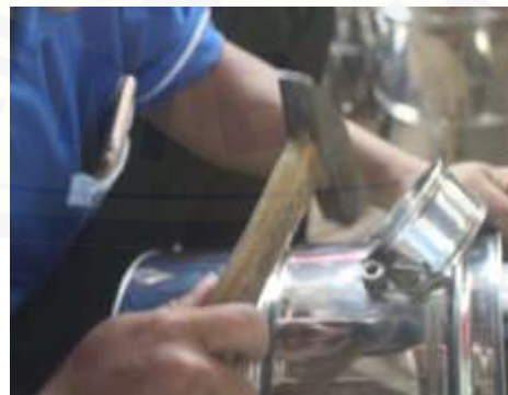
Gambar 2.3 Pemasangan Pegangan Dandang
