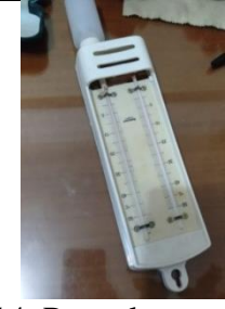
Gambar 14. Pengukuran suhu ruang dengan thermometer bola kering/basah
