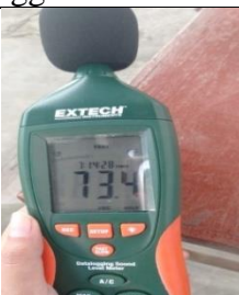
Gambar 15. Pengukuran kebisingan dengan sound level
