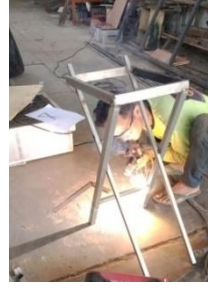
Gambar 10. Proses pembuatan kursi sortasi
