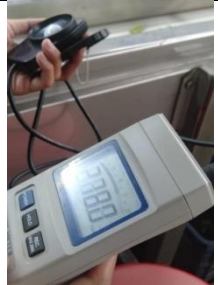
Gambar 13. Pengukuran pencahayaan menggunakan lux meter
