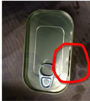
Gambar 2.3 Cacat bocor pada kaleng
