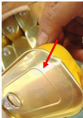
Gambar 2.6 Cacat kembung pada kaleng
