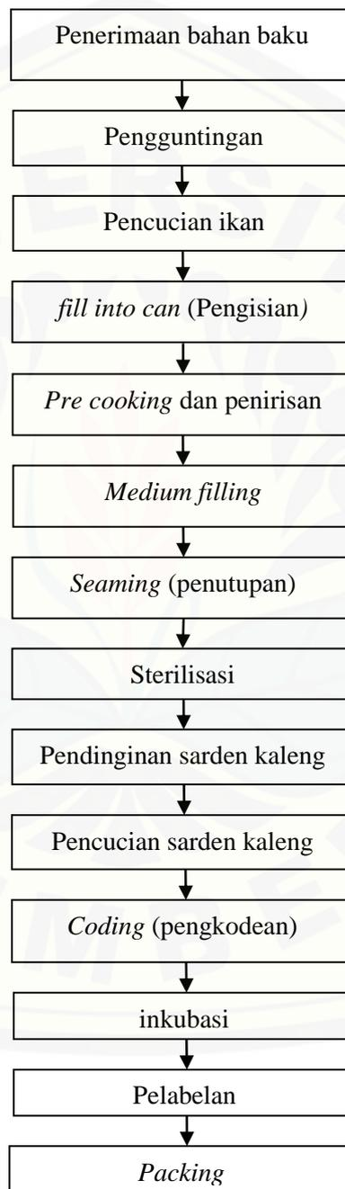
Gambar 2.2 Alur Produksi Proses Produksi.
