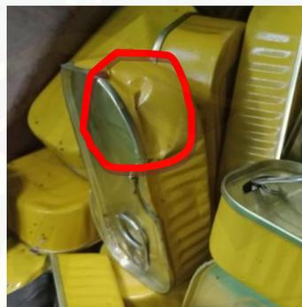
Gambar 2.4 Cacat penyok pada kaleng
