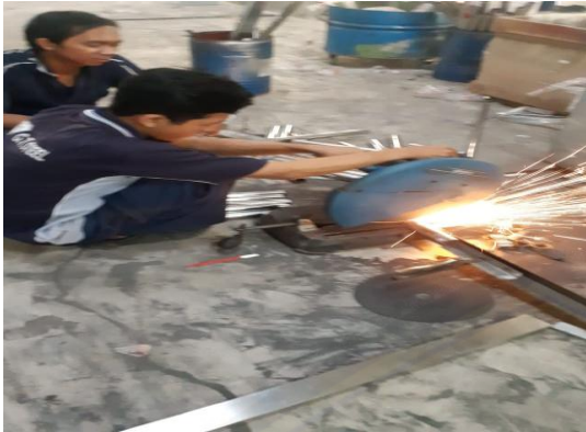
Gambar 17. Pekerja memotong material dengan cutting wheel tanpa menggunakan APD
