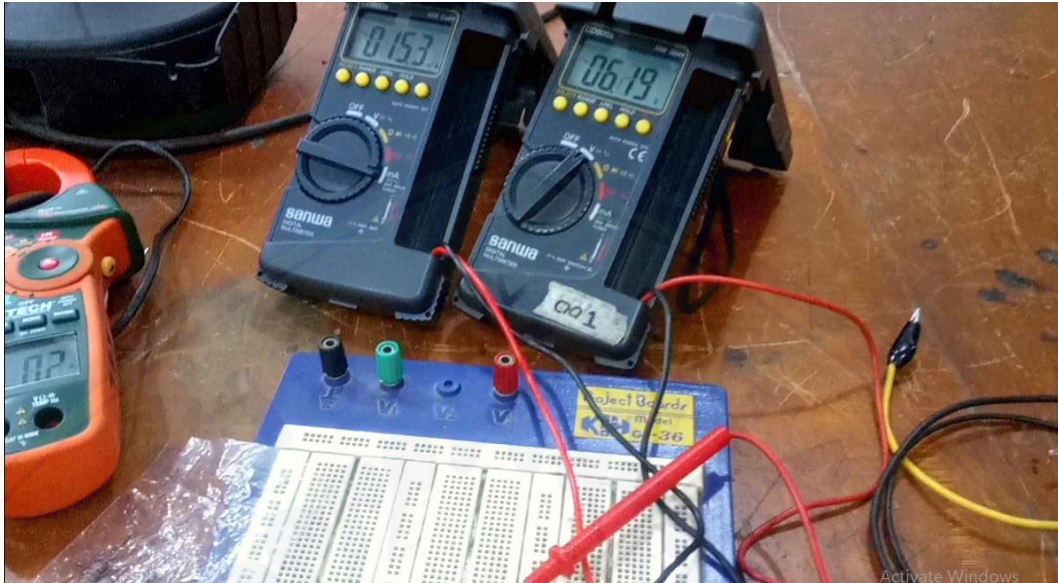
Gambar 1. Pengujian Tegangan dan Arus Output Generator Axial Flux
